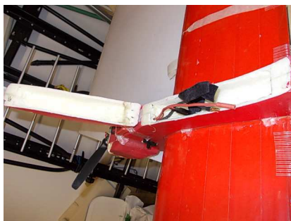
Figure 8 vano batteria aperto
